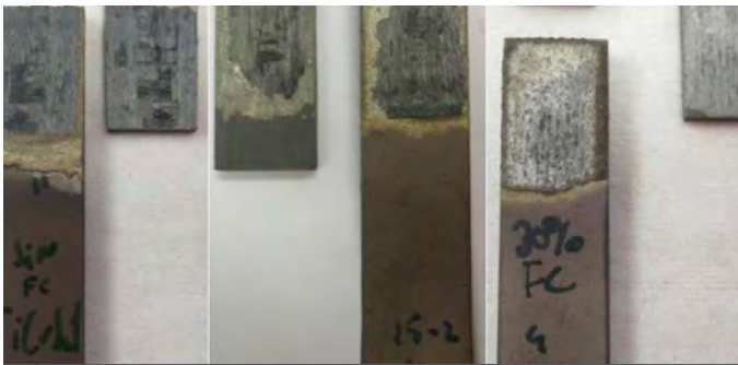
Figura 8. Uniones ensayadas a) con el aporte sin modificar b) 15% de fibras de C y c) 30% fibras de C.
